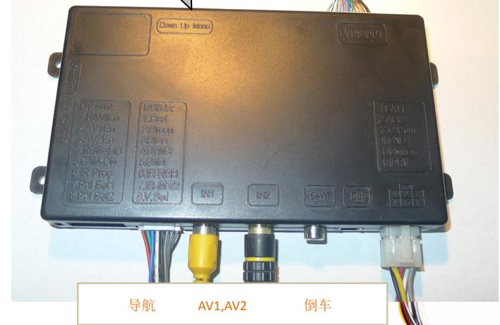
Can 盒的输入线通过源插头，串联到屏后的电源头上。
