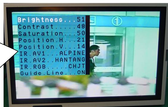
主菜单的最后一个项目设定到 ON 的时候, 将出现倒车轨迹线, OFF 的时候关闭。
