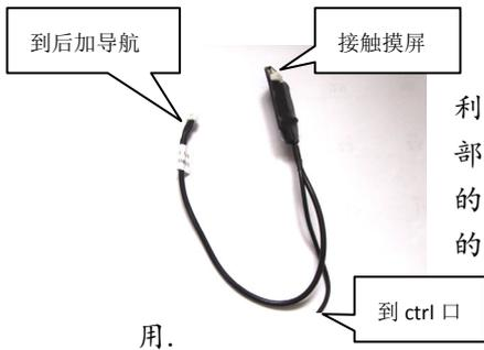
此端口可以连接左图所示的触摸线，利用触摸屏来控制 DVD 和后加设备。它内部带有 1 分 2 的触摸信号开关，在 AV1 输入的情况下，点击触摸屏将出现右图所表示的图标，能够对 DVD 进行操控，在其它的输
