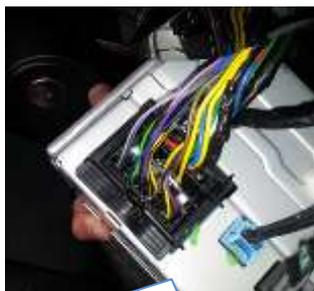
(6) 将 CAN 盒输入的单根线，连接到 CD 后的 GMLAN (28 角) [插头最外侧的单根绿色线]，将添加的功能是：
