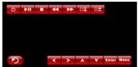
此端口可以连接左图所示的触摸线,利用触摸屏来控制 DVD 和后加设备。它内部带有 1 分 2 的触摸信号开关,在 AV1 输入的情况下,点击触摸屏将出现右图所表示的图标,能够对 DVD 进行操控,在其它的输入通道下,将触摸屏给外加的 RGB 导航使用。
