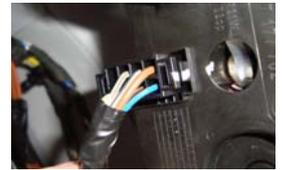
另外一个办法: 在宝马车上, 车灯接头上的 “黄色夹白条” 线是倒车控制线, 倒车的时候, 此线出现 12V, 需要和接口盒的绿色线相连接。
