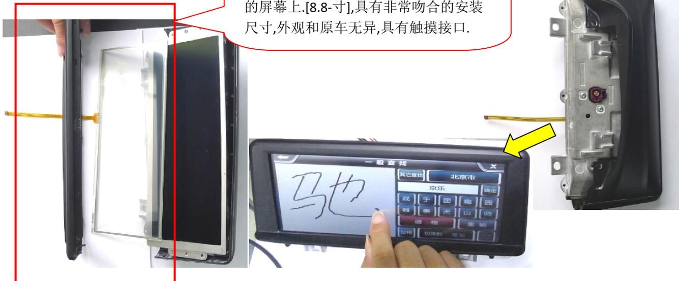
宝马F20不需要这样的触摸前框,因为它的LCD前面没有玻璃层,安装者可以直接将触摸屏安装在前框和液晶之间.
