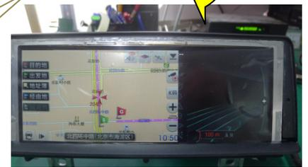
京乐驰的 FV\_Touch\_F30, 包括一个面框和一个触摸屏,能够正好套在 F20,F30 的屏幕上.[8.8-寸],具有非常吻合的安装尺寸,外观和原车无异,具有触摸接口.
