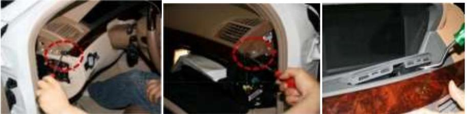
如上图用正确的工具把司机和乘客座旁边的螺丝钉拧开然后拆开空调饰板。
