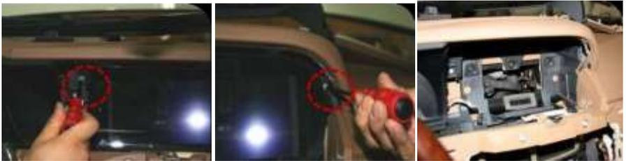
把红圈部分的螺丝钉拧开后用正确的工具拆开原车屏幕。
