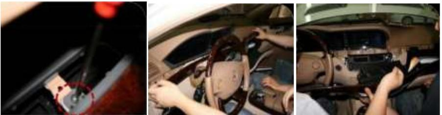
拆开空调饰板后把里面的螺丝钉拧开然后拔出 Glove Box
