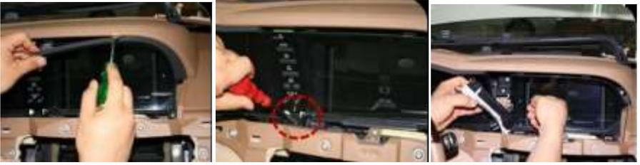
如上图先把屏幕上面的盖子拆开后再拧开红圈部分的螺丝钉，然后拆开屏幕左边的按键系统。
