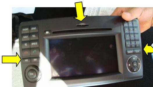
(1) 将主机的显示屏部分的四个固定螺钉卸下 (黄色箭头表示如下), 就可以将整个显示部分取出
