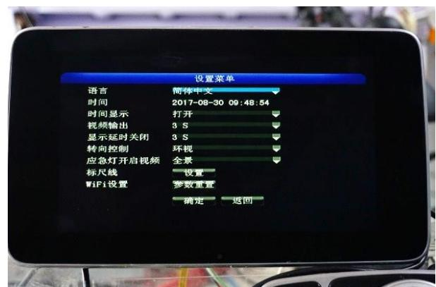
2.选择控制设置并进入，此界面下可以设置时间和延时显示时间。进入标尺线设置。
