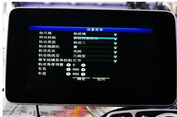
6.数据触发：转向控制设为“协议控制转向”，
